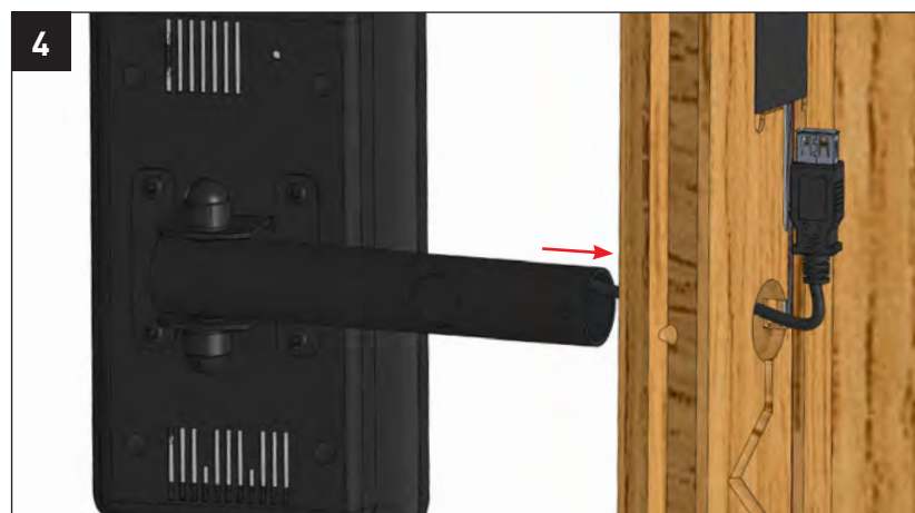
4 Insérez la tige du support de la tablette ainsi que le câble USB dans le cadre principal, de manière à ce qu'ils soient alignés avec les trous de vis. Insert the tablet holder rod along with the USB cable into the main frame, so that it is aligned with the screw holes.
