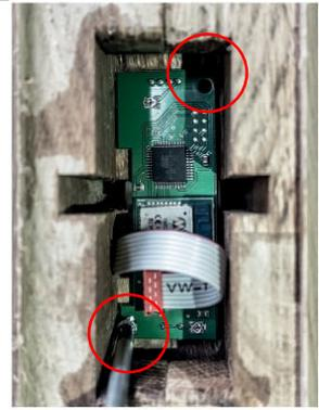
3. Desserrez les deux vis de fixation. L'une se situe en bas à gauche et la seconde en haut à droite.
