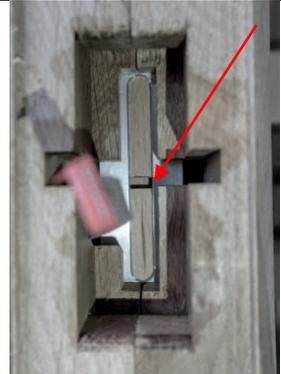
6. La fente dans le bloc de résistance du vélo NOHRD doit s'aligner aux encoches de la structure bois du NOHRDBike.
