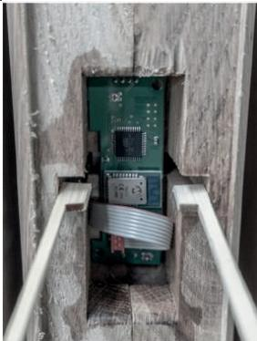
4. Insérez les 2 tiges en bois dans les encoches latérales. Serrez les 2 tiges en bois derrière la carte et retirez délicatement la carte.
