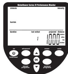
Allez jusqu'à la fenêtre Distance à l'aide du bouton "workout programs" (les chiffres de la distance apparaissent avec les indicateurs "distance" et d'unités de distance, l'indicateur "workout" clignote et la barre de zone monte jusqu'à HI). Allez jusqu'à la distance d'exercice désirée à l'aide des boutons flèches.
